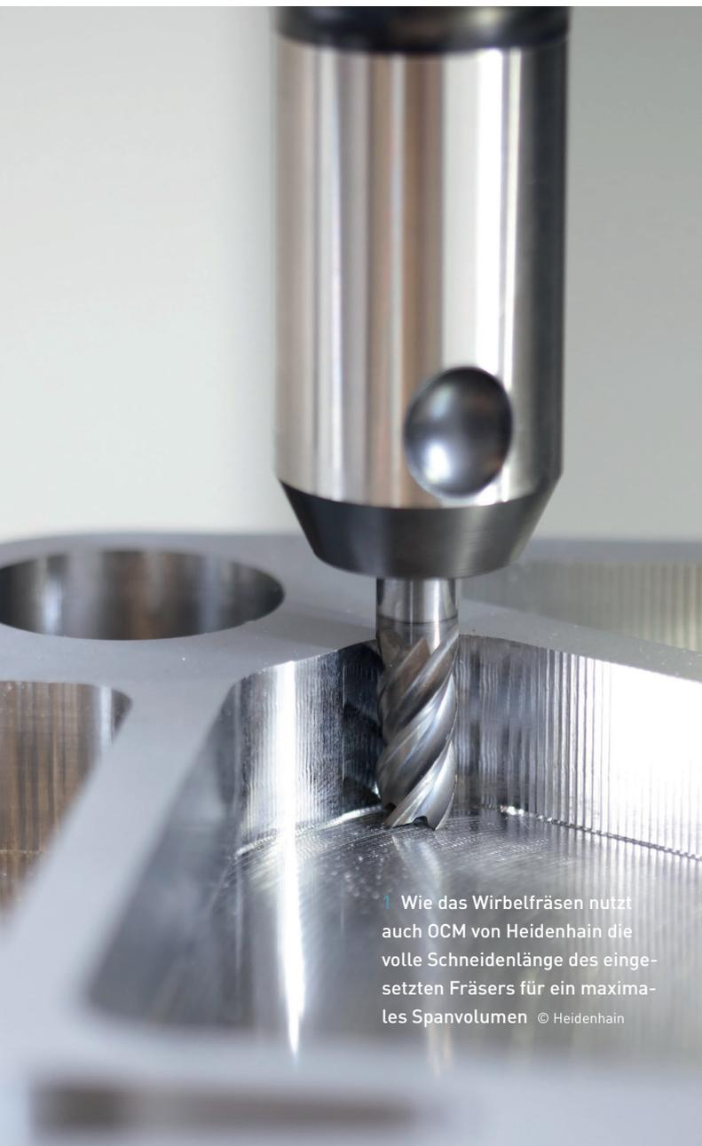
Wie das Wirbelfräsen nutzt auch OCM von Heidenhain die volle Schneidenlänge des eingesetzten Fräasers für ein maximales Spanvolumen © Heidenhain
